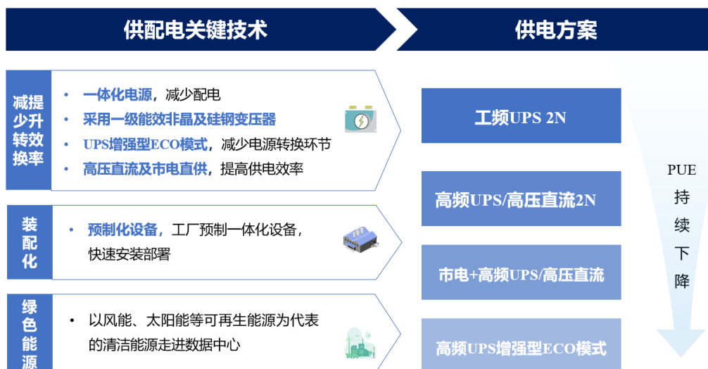
图3 数据中心供电关键技术及对 PUE 的影响
