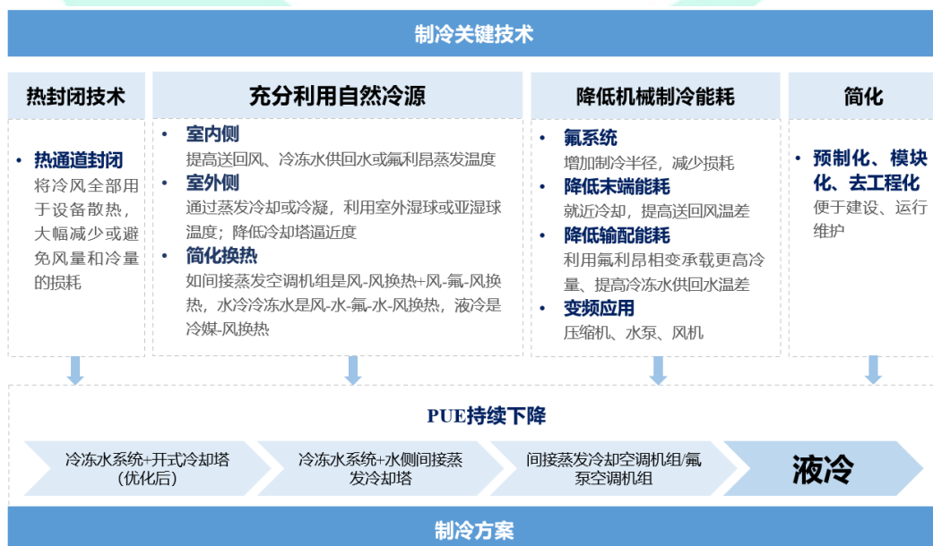
图 7 数据中心制冷关键技术及对 PUE 的影响
