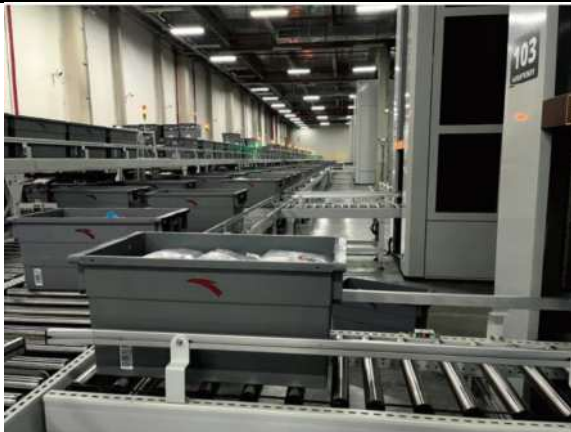
图 12：环形输送线设计减少机器人搬箱次数
