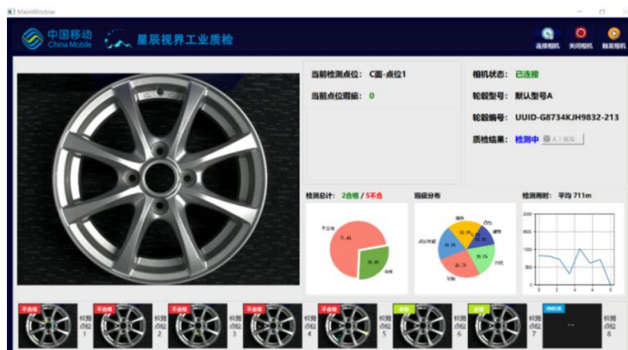
图 3.2 星辰视界轮毂表面瑕疵检测系统
