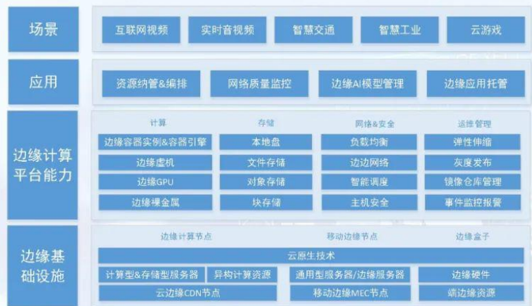
图 9 边缘智能布局架构 4
